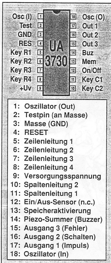
Bild 1: Aufpasser im Tastenschloß ist dieser 18polige CMOS-Schaltkreis.
